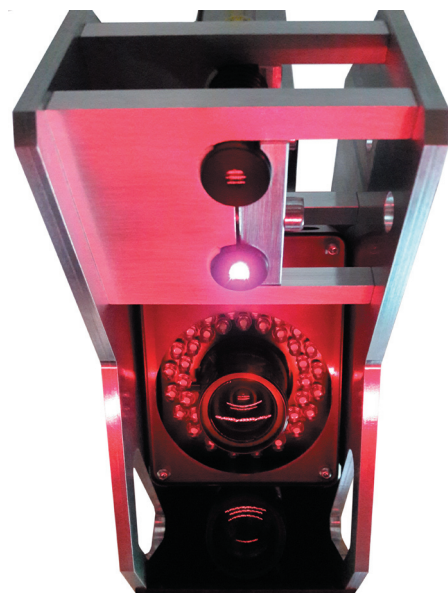
Obr 7: Pohyblivá hlava se dvěma kamerami DataCam a dvěma laserovými projektorovými čar
